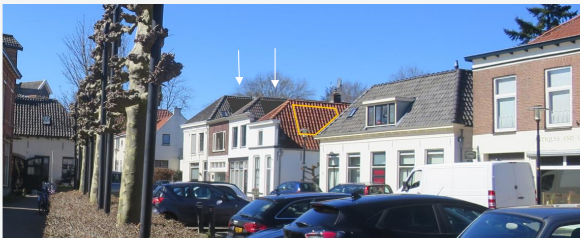
Geel omkaderd vlak; hier geen zonnepanelen en -collectoren plaatsen. Het bouwwerk ligt aan deze zijde niet aaneengesloten in de rij met het naastgelegen bouwwerk. De impact van de zonnepanelen en -collectoren op het straatbeeld wordt daardoor te groot.
